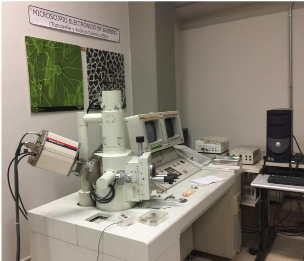
**Figura 11. Microscopio JEOL modelo JSM-5300 y detector EDAX SuperDry II**
