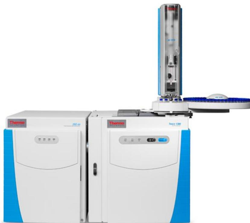
**Figura 13. Espectrómetro de masas (GC/MS) Thermo Scientific™ TRACE™ 1310**
