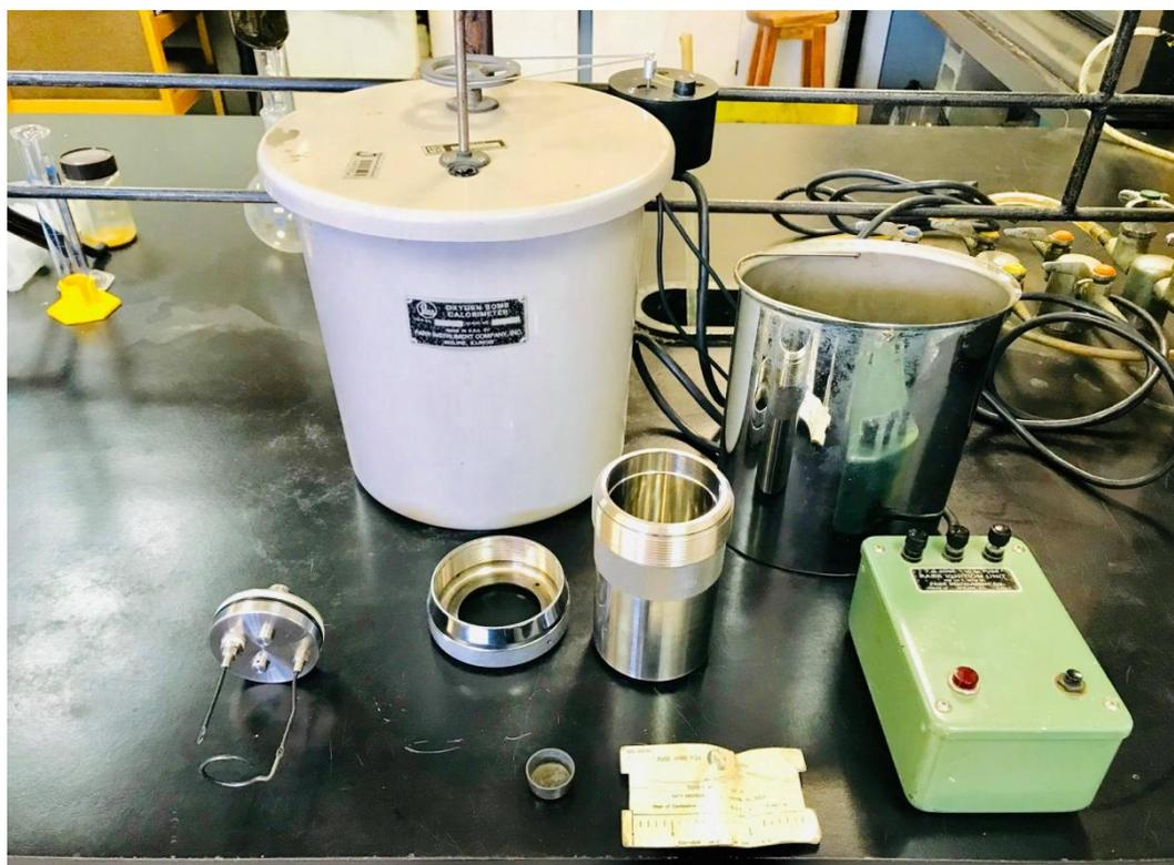
**Figura 15. Calorímetro de bomba de oxígeno de la marca Parr instrument company, Inc., utilizado para medir en calor de combustión en los productos líquidos obtenidos en la descomposición del PEBD.**
