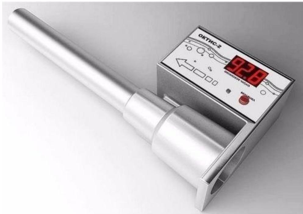
**Figura 14. Octanómetro portátil modelo OKTNC-2 utilizado para la medición del octanaje en los productos líquidos obtenidos en la descomposición del PEBD**
