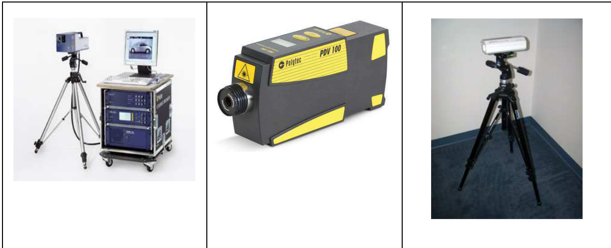
Fig. 7. En esta imagen se muestran dispositivos LDV para medir la vibración: PSV-I-400, PDV-100 y LP01-HF. Las imágenes pueden ser consultadas en los siguientes enlaces: http://www.hysen.com/product/view.php?id=23&no=3&cat_no=&offset= , https://www.polytec.com/eu/vibrometry/products/single-point-vibrometers/pdv-100-portable-digital-vibrometer/y https://www.omscorporation.com/products/LP01-HF/accessories.html
