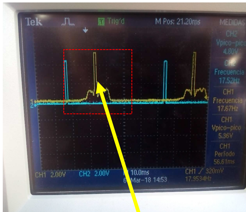
Fig. 36. Captura con fototransistor PT1302B/C2 y fuente de referencia activa.
