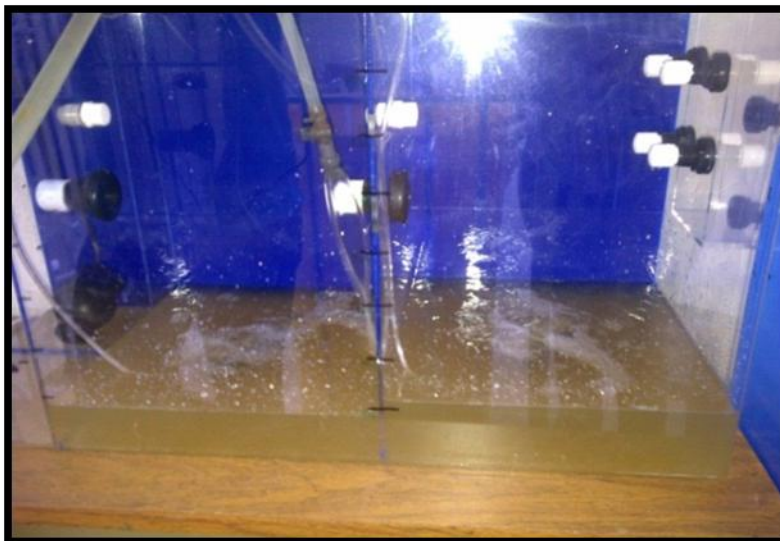
Foto 16. Arranque de la PTAR a nivel escala con agua cruda de la PTAR-UABC Guadalupe Victoria
