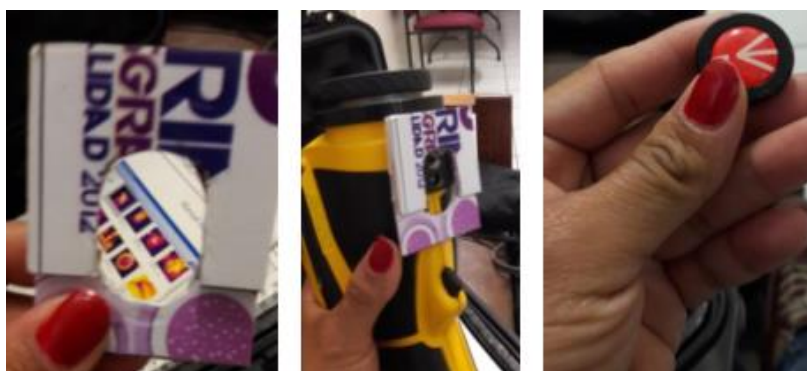
Figura 9 Colocación de parte para ajuste de la cámara al trípode.
