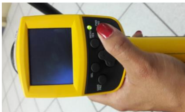
Figura 5: Indicaciones para encender cámara termográfica
