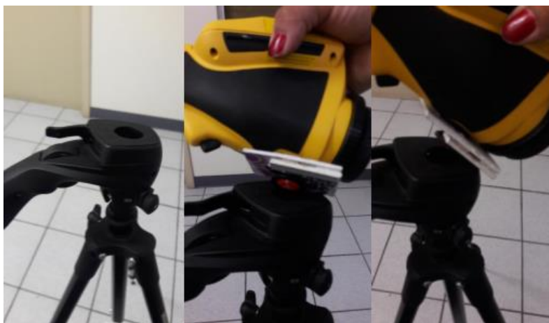
Figura 10 Ensamblaje de cámara a tripié.
