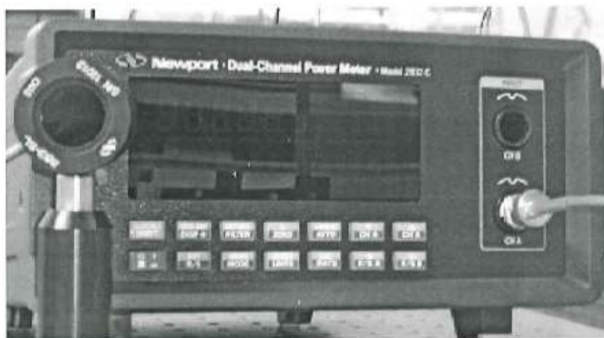
Figura 5.5 Medidor de potencia Newport modelo 2832-C, con un detector de germanio para una longitud de onda alrededor de 1500 nm.
