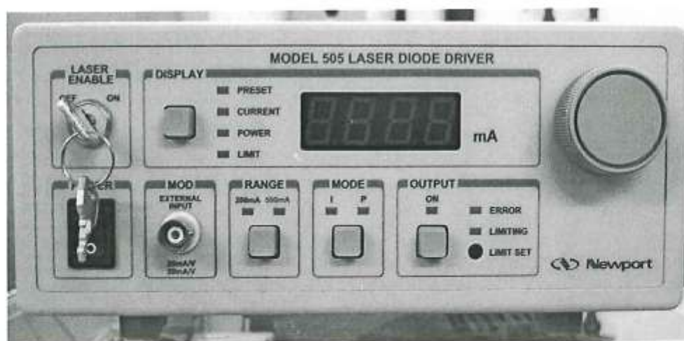
Figura 4.6 Fuente de alimentación Newport modelo 505, con salida de 500 mA.
