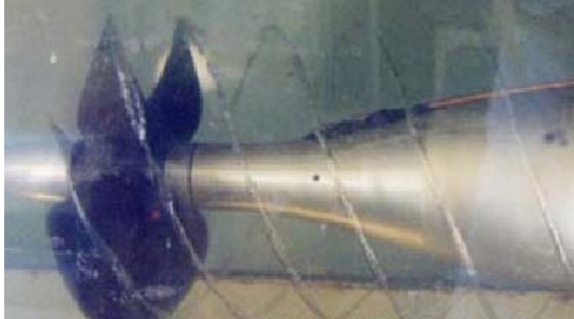
Figura 2.12 Fenómeno de cavitación en propela.
