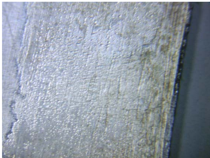
Figura 4.9 Evaluación de la superficie del acero en agua y sólidos ( 149\text{ }\mu\text{m} ), velocidad de rotación 550 (RPM). Se aprecia que con el cambio de velocidad incrementan los impactos.
