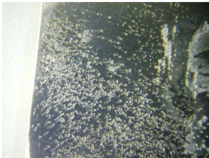
Figura 4.7 Evaluación de la superficie del acero en agua. Se observa un mayor impacto en el patrón corrosivo por la velocidad de rotación de 550 (RPM).
