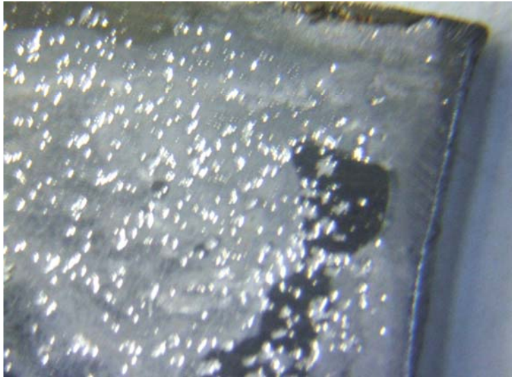
Figura 4.6 Evaluación de la superficie del acero en agua. Se aprecia el patrón corrosivo sobre la superficie a una velocidad de rotación de 350 (RPM).
