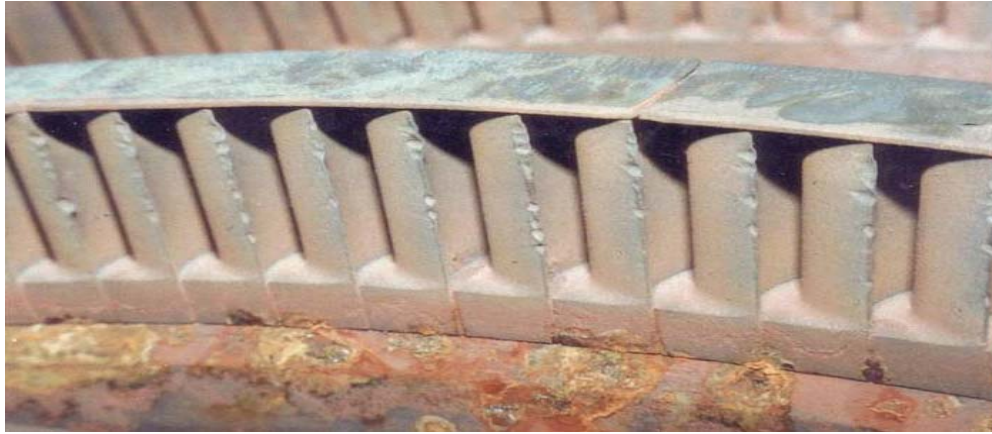
Figura 1.3 Erosión-corrosión sobre el rotor y los álabes mostrando el patrón direccional. (Fuente: Materials Performance Vol.48, Septiembre 2009)
