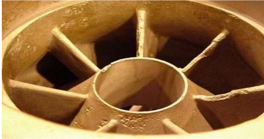
Figura 2.11 Álabes de bomba afectada por erosión-corrosión en la succión. (Fuente: www.nace.org )
