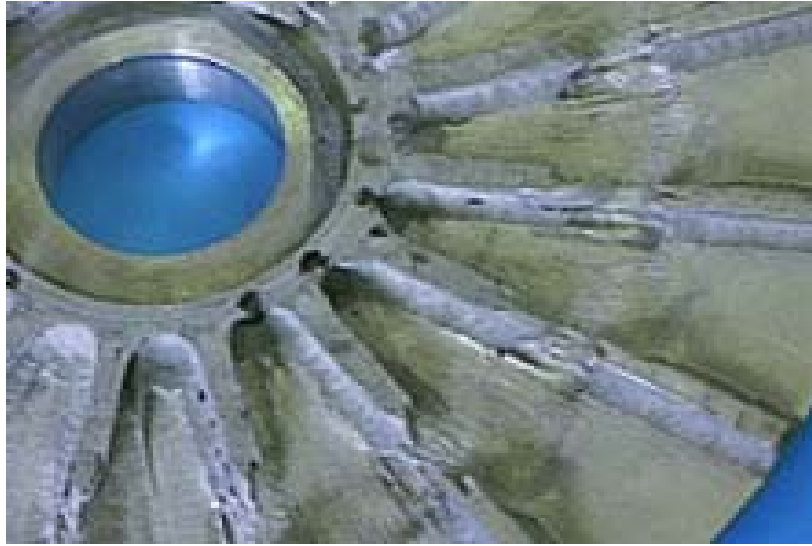
Figura. 2.15 Álabes de una bomba de aleación níquel en ácido clorhídrico afectada por cavitación.
