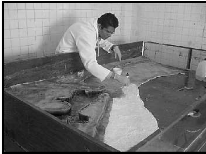
FIGURA 4. Construcción del modelo a escala de la zona portuaria y la playa municipal de Ensenada
