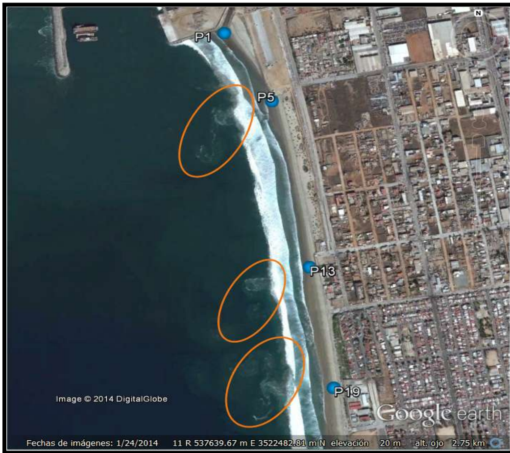
FIGURA 15. Localización de los transectos donde se ubican los cambios en las corrientes de la playa municipal de Ensenada, B.C. Así como las corrientes de retorno, ubicadas frente a ellas (círculos naranjas). DigitalGlobe 24/enero/2014.
