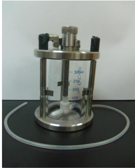
Figura 3.8. Celda Millipore resistente a solventes, utilizada para filtración de etanol.
