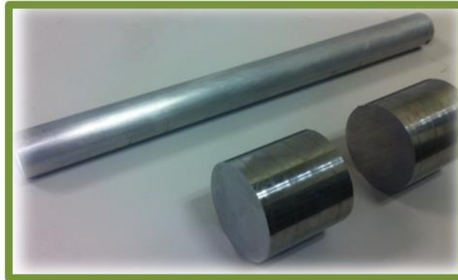
Figura 20.- Mangas de acero 4140 como pieza ferro magnética, junto con una barra de aluminio.
