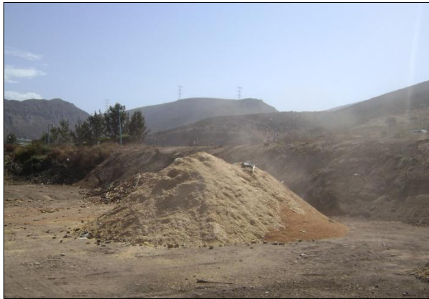
Fig. 1. Compostaje de lodos residuales, PTAR "El Naranja" Ensenada, B.C.
