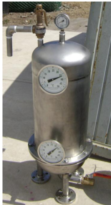
Figura 1. Prototipo experimental de digester anaerobio fabricado en acero inoxidable con termómetros para biogás y lodos residuales, así como válvula de seguridad y llave de drenado (Fotografía propia).
