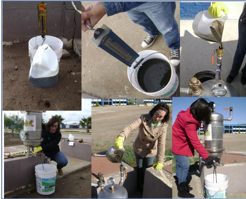
Figura 13. Pesaje, alimentación y drenado de lodos residuales para los experimentos realizados (Fotografías propias).
