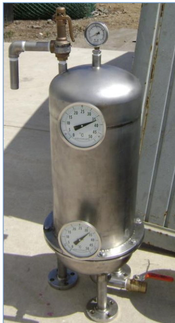
Figura 11. Prototipo experimental de digestor anaerobio fabricado en acero inoxidable con termómetros para biogás y lodos residuales, así como válvula de seguridad y llave de drenado (Fotografía propia).
