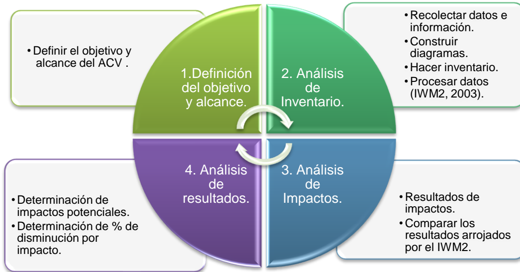
Figura 14. Metodología del ACV realizada en el presente estudio basado en Hoof (2008), Elaboración propia.
