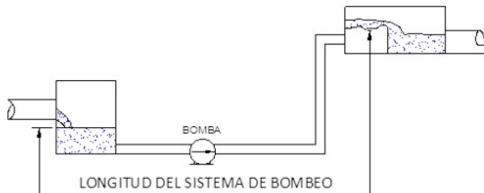
Fig. 2.1 Límites de un sistema de bombeo.
