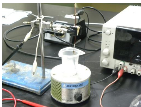
Figura 19. Celda electroquímica utilizada para el anodizado de Ti y Ti6Al4V en solución electrolítica compuesta de \text{NH}_4\text{F} /Etilenglicol/agua electroquímicamente purificada.
