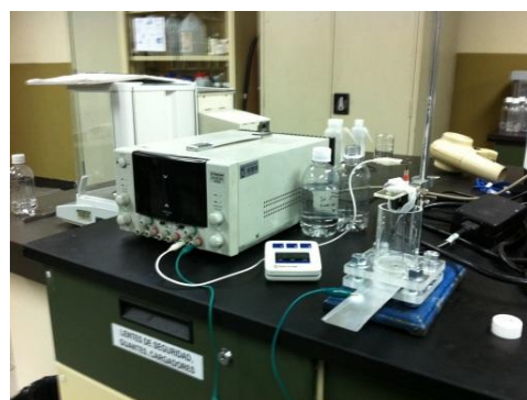
Figura 19. Celda electroquímica utilizada para el anodizado de Ti y Ti6Al4V en solución electrolítica compuesta de \text{NH}_4\text{F} /Etilenglicol/agua electroquímicamente purificada.
