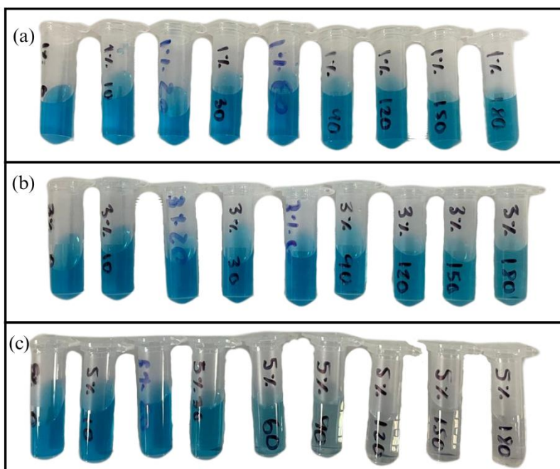
Figura 17. Alícuotas de la degradación de azul de metileno con NPs de ZnO al (a)1%, (b) 3% y (c) 5%.
