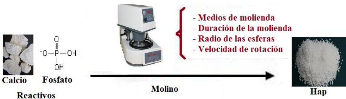
Figura 4. Síntesis de HAp por mecano química [14]
