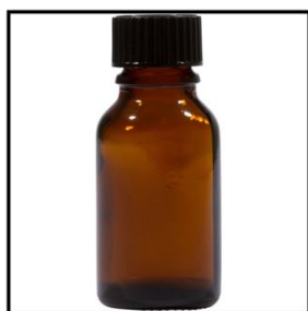
Figura 3.2.2 Botella de vidrio ámbar de 30 ml utilizada para contener las muestras para el análisis de oxígeno-18 y deuterio.
