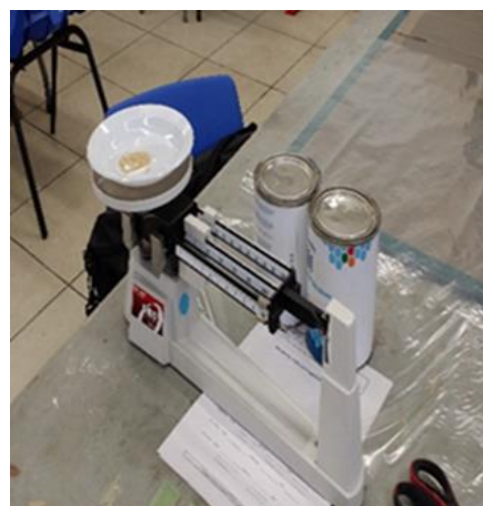
Figura 72 Mezcla 1 a 1 de las dos partes del adhesivo.
