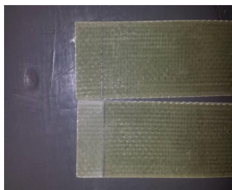
Figura 69 Cupón de prueba después del tratamiento superficial de lijado y uno sin tratamiento
