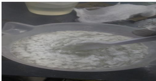
Figura 55 Mezcla de resina con fibra molida
