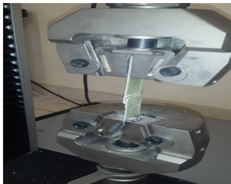
Figura 82 Prueba de tensión, probetas adhesivo epóxico.
