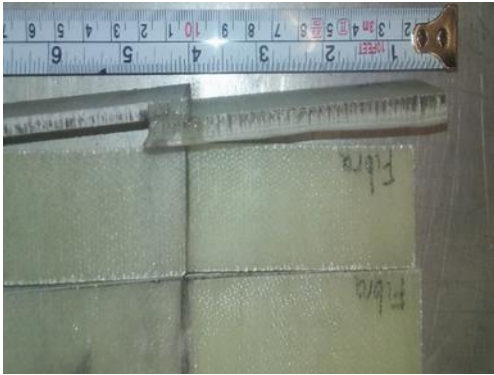
Figura 77 Laminados separados unidos con resina
