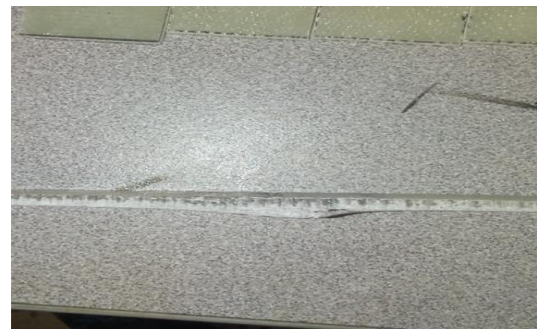
Figura 80 Probetas unidas con resina mezclada con fibra de vidrio molida
