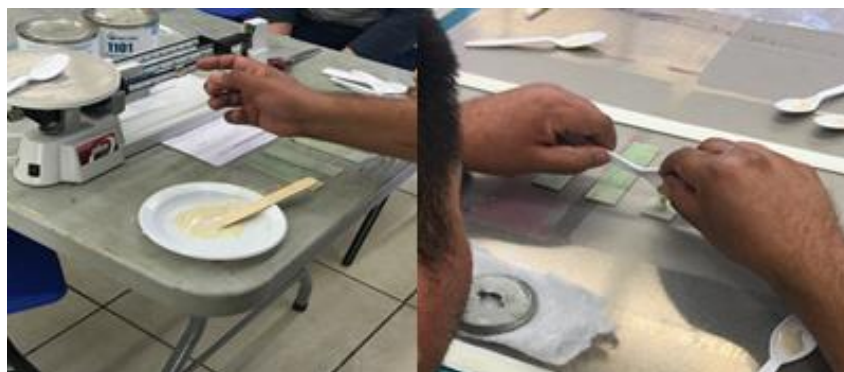
Figura 73 Se pesa y vierte el adhesivo en los cupones de prueba
