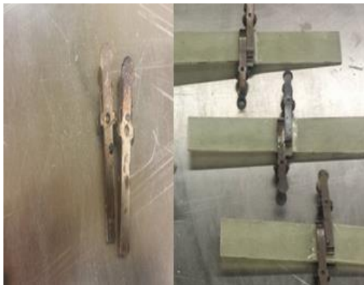
Figura 74 Abrazadera (clamps) utilizados para realizar la unión de los dos cupones.
