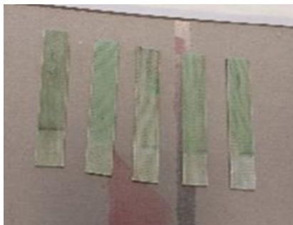
Figura 70 Cupones de prueba dejando secar después de limpiarlos con acetona el área del tratamiento
