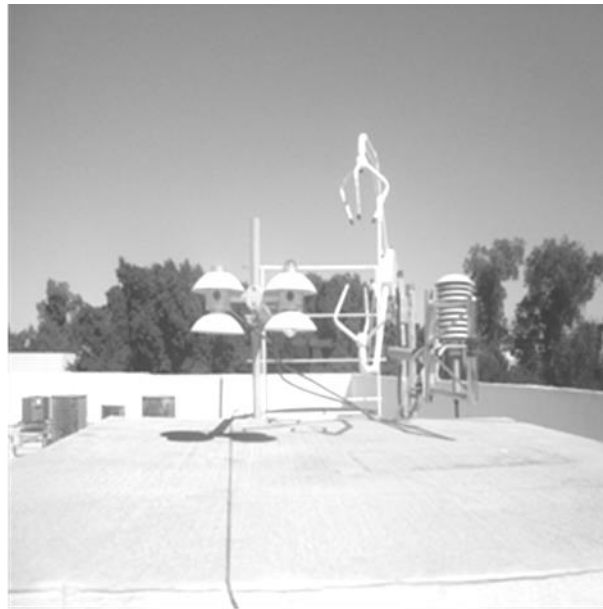
Figura 3. 2: Ubicación de sensores de radiación neta, flujos de calor y temperatura superficial sobre el experimento.
