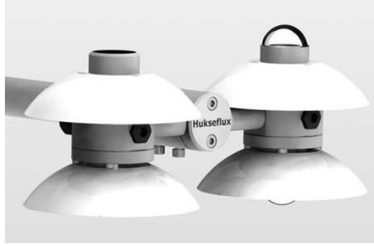
Figura 2. 14: Sensor NR01 (sensor de cuatro componentes de radiación neta). Fuente: Campbell Scientific, Inc.
