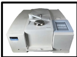
Figura 4-2 Espectrómetro FTIR Perkin Elmer Spectrum One.
