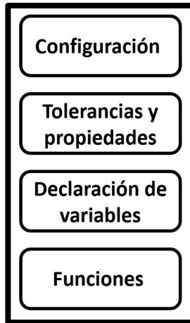
Figura 3-1 Estructura general de un postprocesador CNC.
