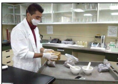
Figura 24. Molienda y tamizado de escoria
