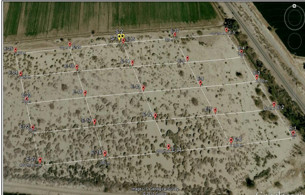
Figura 15. Imagen aérea que muestra el trazado de retícula en el sitio de almacenamiento de escoria Fuente: Google earth, 2013
