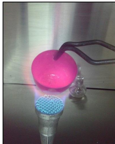
Figura 28. Escoria y fundente completamente líquidos
