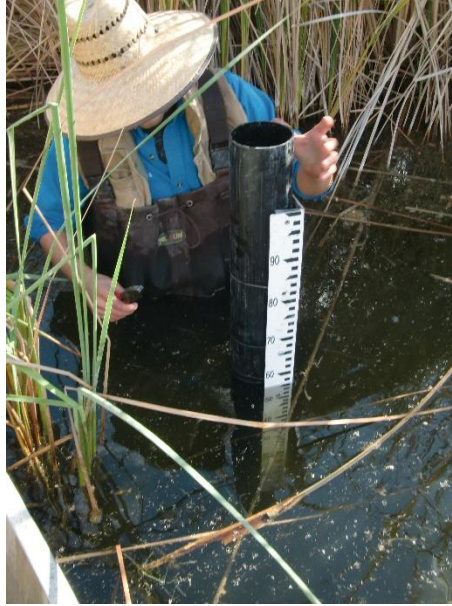
Figura 11. Regleta instalada y sujeta a una solera que es enterrada en el suelo firme; a un costado se observa el tubo donde se introduce el sensor HOBOT.
