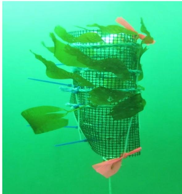
**Fig. 3** Unidades de flotación diseñadas *ad hoc* para el cultivo experimental de juveniles *M. pyrifera* a 3 y 10 m de profundidad.
