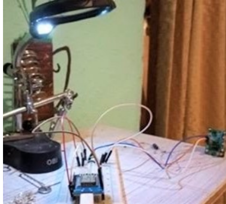
Figura 3.22: Prueba de dispositivo para el monitoreo de movimiento
