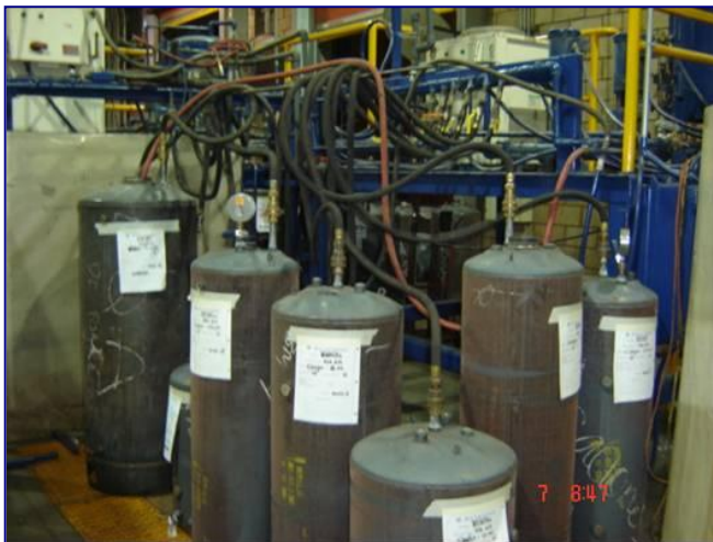
Fig. No 15.1. Arreglo de tanques en prueba de pulsaciones.
