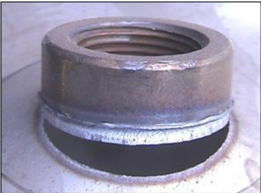
Fig. No. 14.1 Soldadura aceptable debido a que el material base se desprendió al 100%
