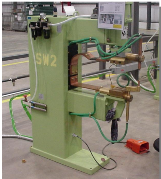
Fig. No. 7 Maquina de soldadura de resistencia de punto de tipo prensa.
