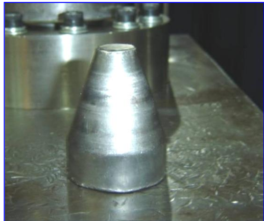
Fig. No. 13.2 - Punzón para prueba de desprendimiento
