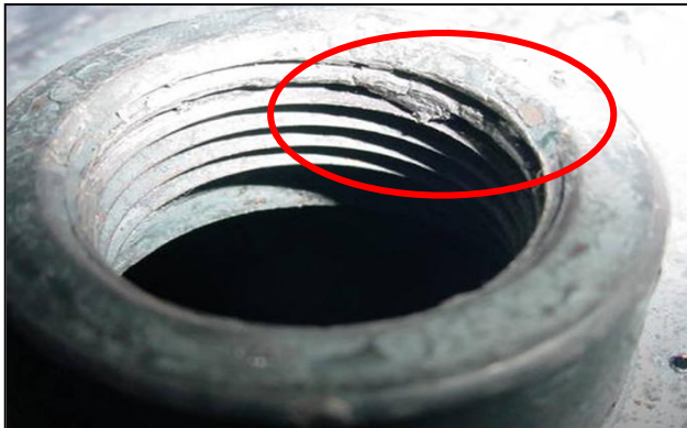
Fig. No. 14.3 – Material depositado en las cuerdas de la rosca.
