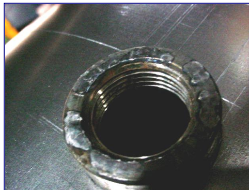
Fig. No. 14.6 – Material no rechazado pero que indica marcas de sobrecalentamiento. Los electrodos se han visto afectados.
