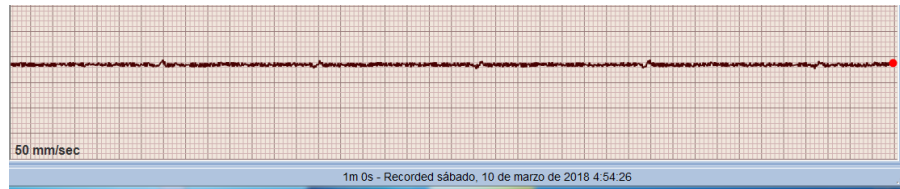
Figura 4.30 Señal ECG con circuito para aplicación cerca del pecho (THEREMINO).
