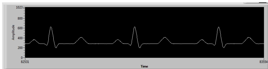
Figura 3.36 Señal de ECG ideal transmitida por módulo bluetooth en LABVIEW.
