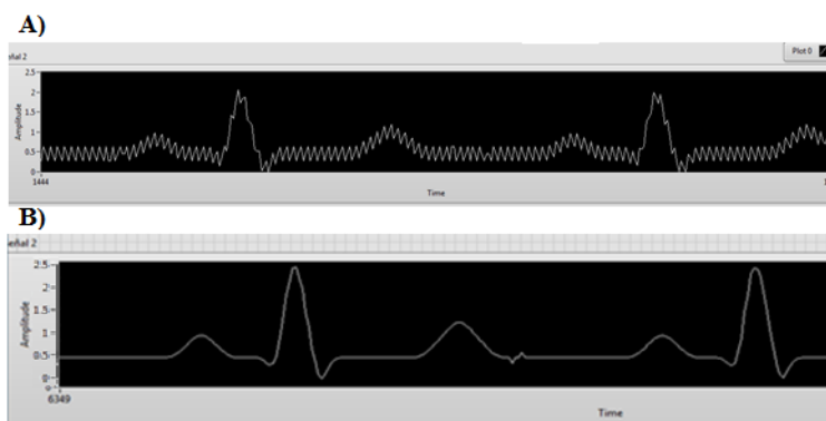
Figura 3.46 A) Señal de ECG con ruido 60Hz. B) Señal filtrada. Transmitidas por puerto serie visualizadas en software LABVIEW.
