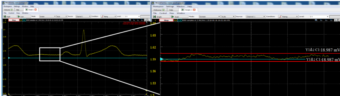
Figura 4.4 Medición de ruido en señal de ECG adquirida con circuito de prueba #1 con paciente. Se realizó un ajuste en la escala hasta 30mV/Div, para observar las variaciones sobre la línea basal de la señal ECG.
