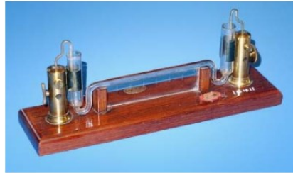
Figura 1.2 Galvanómetro capilar creado a partir del electrómetro capilar de Lippmann [3]. Fuente: Memoria Holter, pag. 12 Universidad Politécnica de Catalunya
