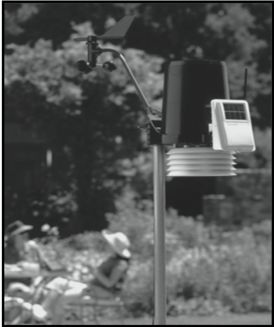
Imagen 3 Estación meteorológica WeatherLink en funcionamiento tomada del manual de usuario
