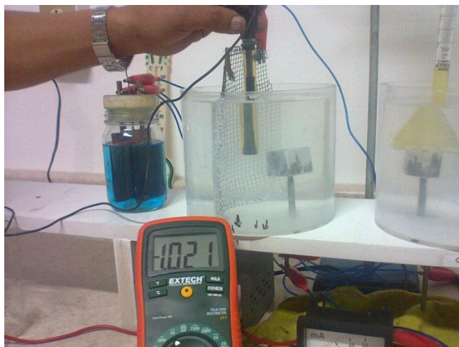
Figura 23 medición de potencial a circuito cerrado
