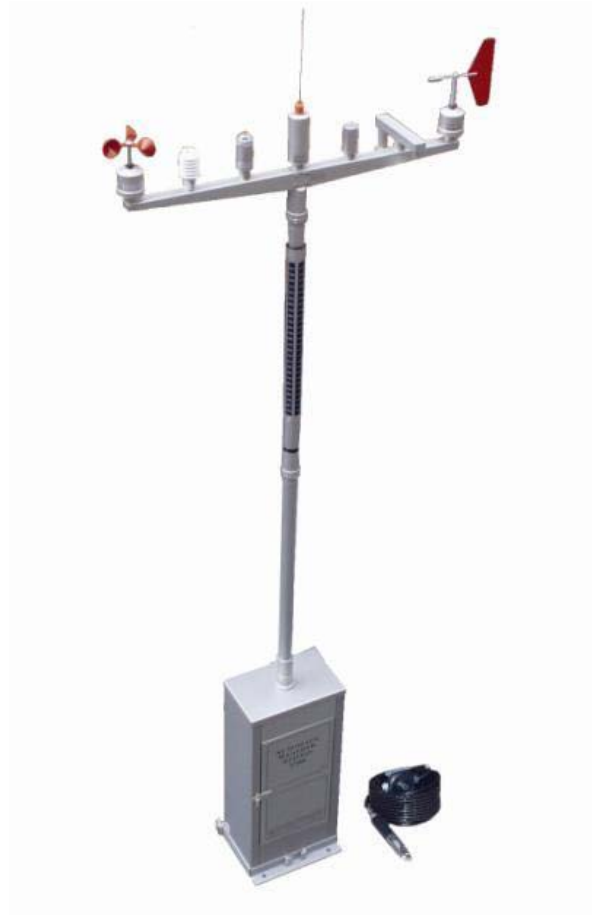
Figura 2. Estación Meteorológica Aanderaa Instruments tipo AWS2700, ubicada en Cabo Pulmo, BCS.
