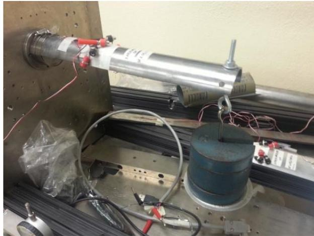
Figura 4.26. Sistema para medición de esfuerzo en medio cilindro.
