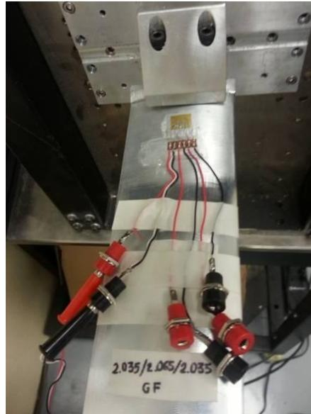
Figura 4.39. Conexión de galga.
