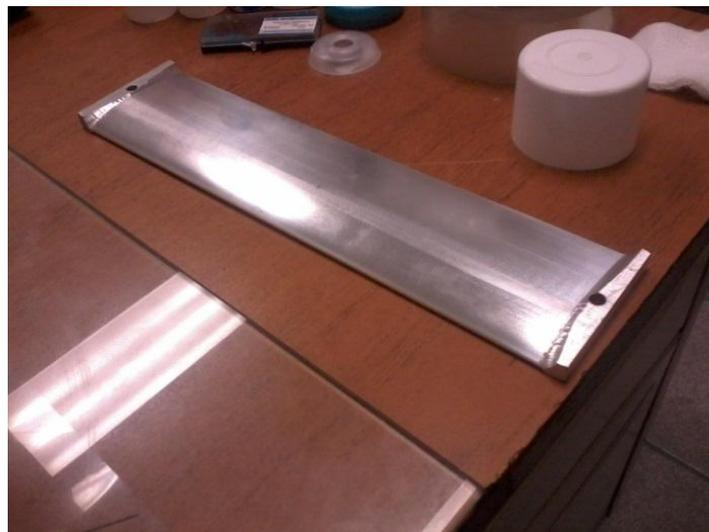
Figura 4.38. Semiala obtenida después del proceso de maquinado por CNC.
