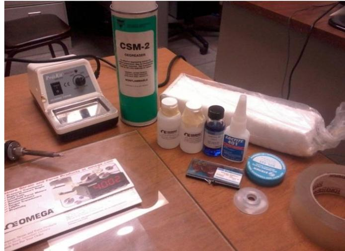
Figura 4.37. Equipo para preparación de roseta rectangular.
