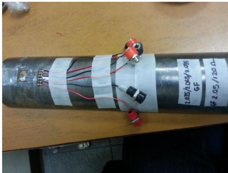
Figura 4.29. Conectores para fácil intercambio de cable de adquisición de datos.
