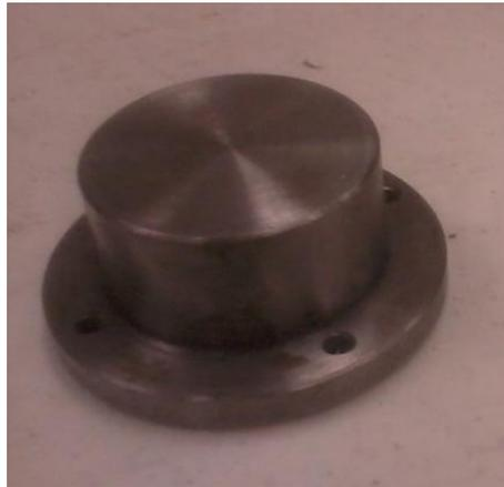
Figura 4.27. Diseño y fabricación de aditamento para empotramiento de medio cilindro.
