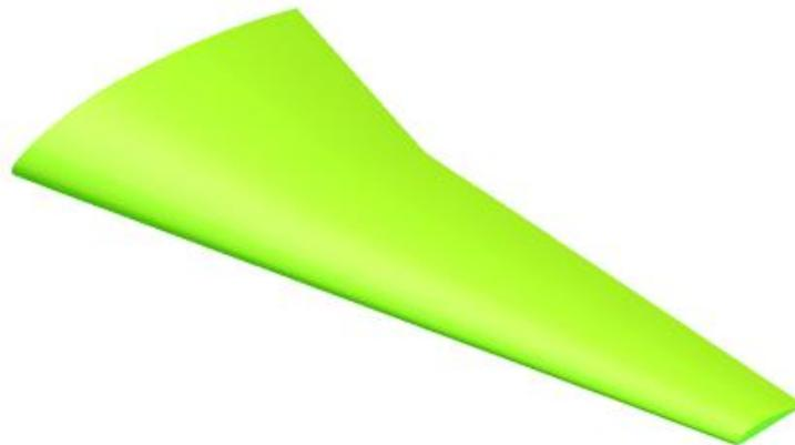
Figura 4.7. Modelo de ala sólida perfil NACA 4412.
