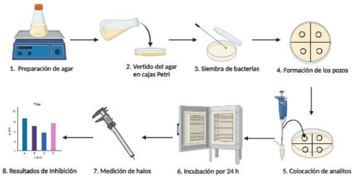
Figura 16. Metodología general de las pruebas microbiológicas para las Ag-NPs y Cu x O-NPs frente a bacterias de E. coli y S. aureus .
