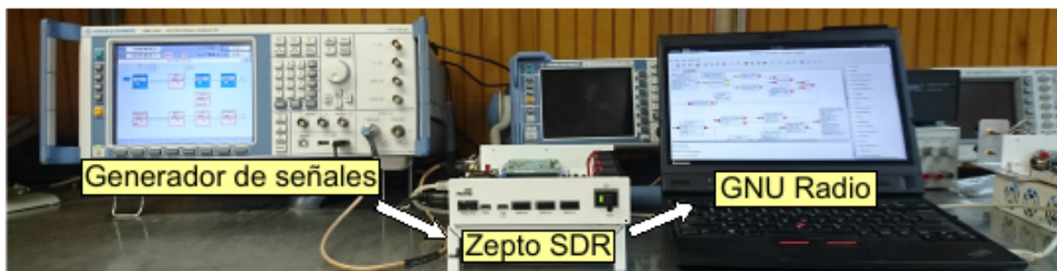
Figura 7: Equipo utilizado para llevar a cabo el análisis experimental del detector de energía.
