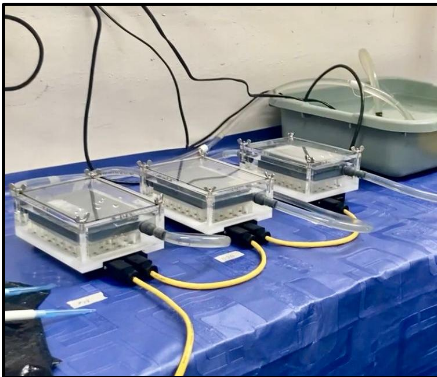
Figura 2. Sistema de respirometría utilizado para la medición del consumo de oxígeno del abulón azul ( H. fulgens guadalupensis ). Cada cámara respirométrica corresponde a una temperatura experimental (20 °C, 23 °C y 26 °C).
