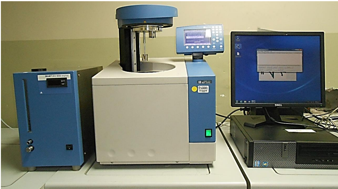
Figura 25. Bomba Calorimétrica IKA C2000.
