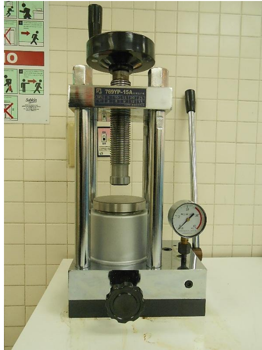
Figura 22. Prensa hidráulica 769YP-15A.
