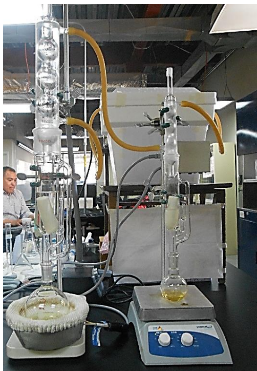
Figura 27. Equipo de extracción Soxhlet.
