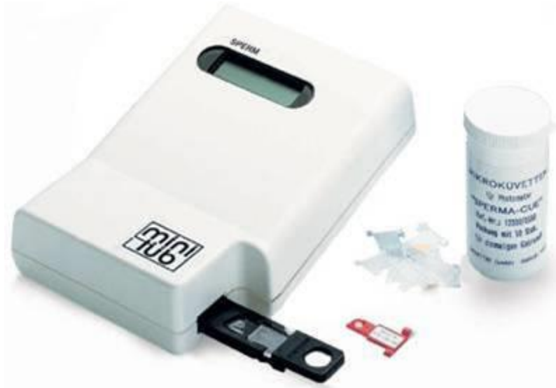
Ilustración 9 Spermacue de Minitub usado para estimar la concentración espermática.
