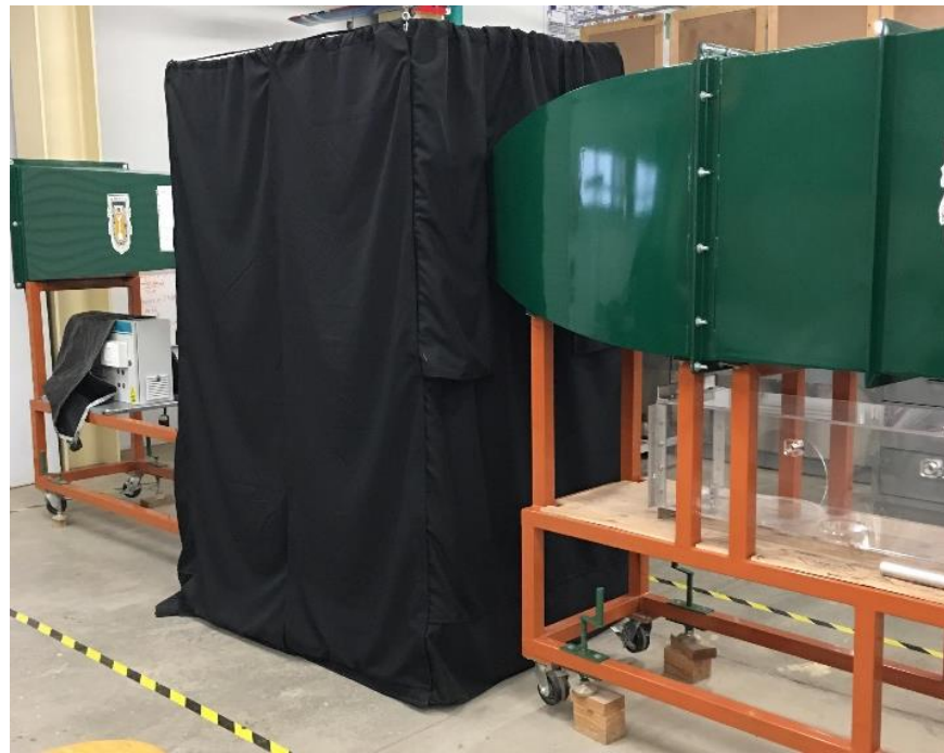
Figura 28.- Caja de luz instalada en el túnel de viento de la FCITEC.
