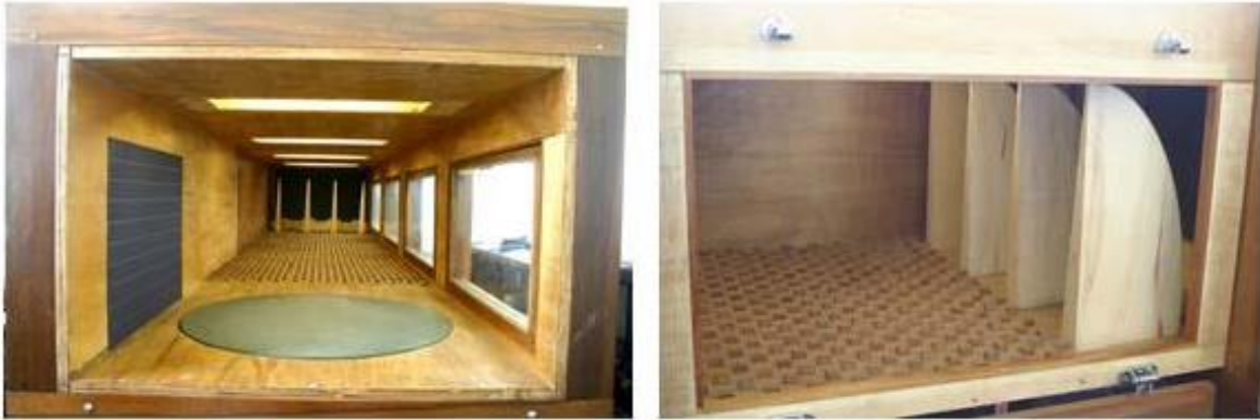
Figura 14.- Vista frontal de Túnel de viento (izq) y obstáculos generadores de turbulencia.
