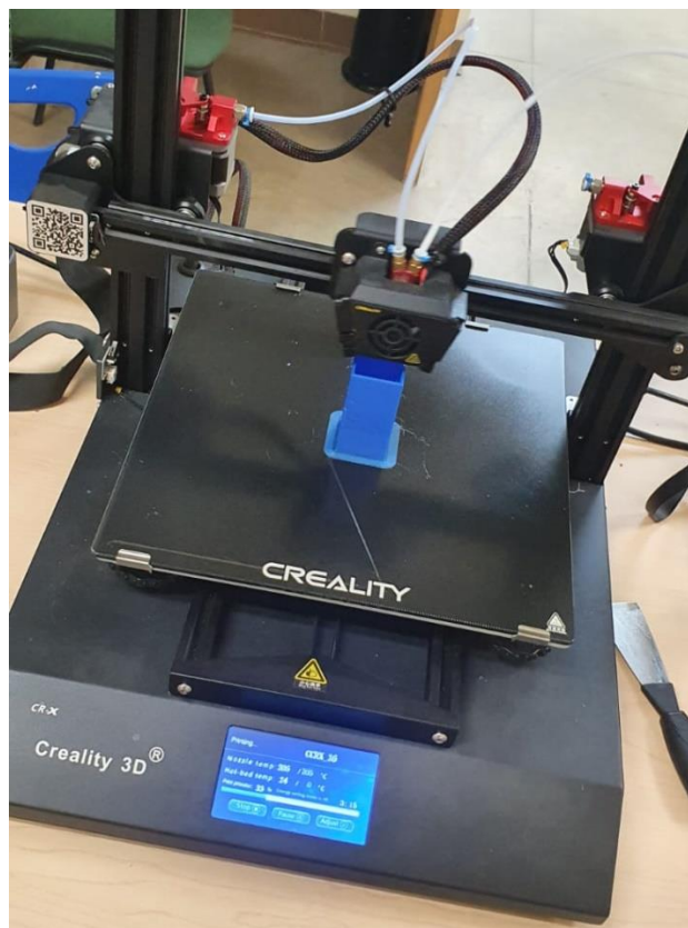
Figura 22.- Impresión de prototipo de medio poroso.
