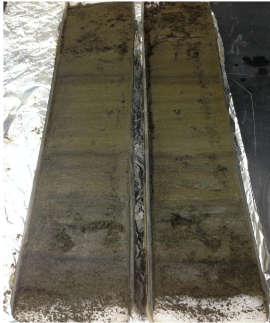
Fig. 6. Núcleo SD-6-MC cortado a la mitad. Se puede apreciar el detalle de las bandas claras y más oscuras que predominan a lo largo de todo el núcleo.
