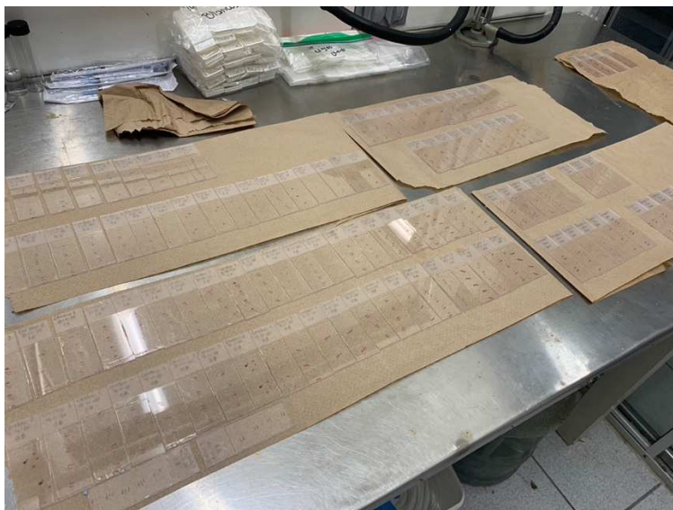
Figura 15. Laminillas con muestras montadas en resina.
