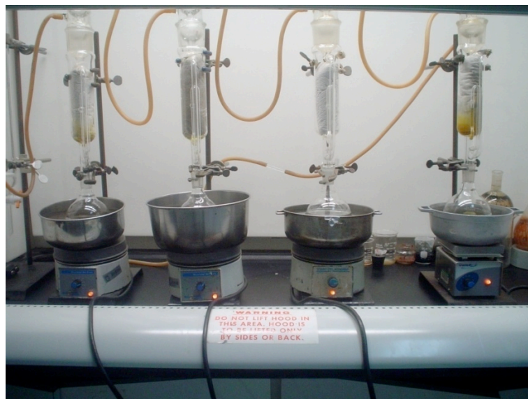
Figura 24. Sistema de extracción Soxhlet
