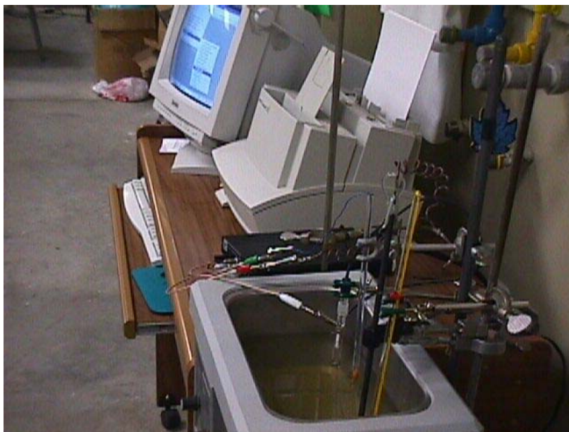
Figura 3.2 Equipos que se emplearon para los experimentos, se observan las conexiones a los tres electrodos empleados en la celda electroquímica de cavitación.
