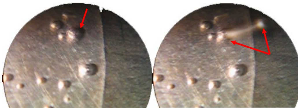
A) Formación de burbujas por cavitación
