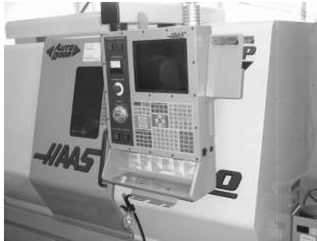
Figura 8. Centro de Torneado CNC.
