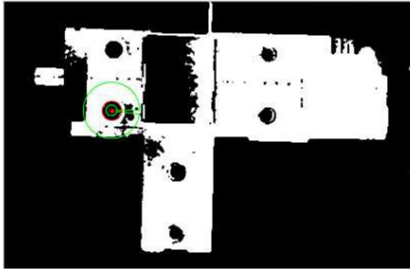
Figura 38. Ejemplo de localización de un borde circular.
