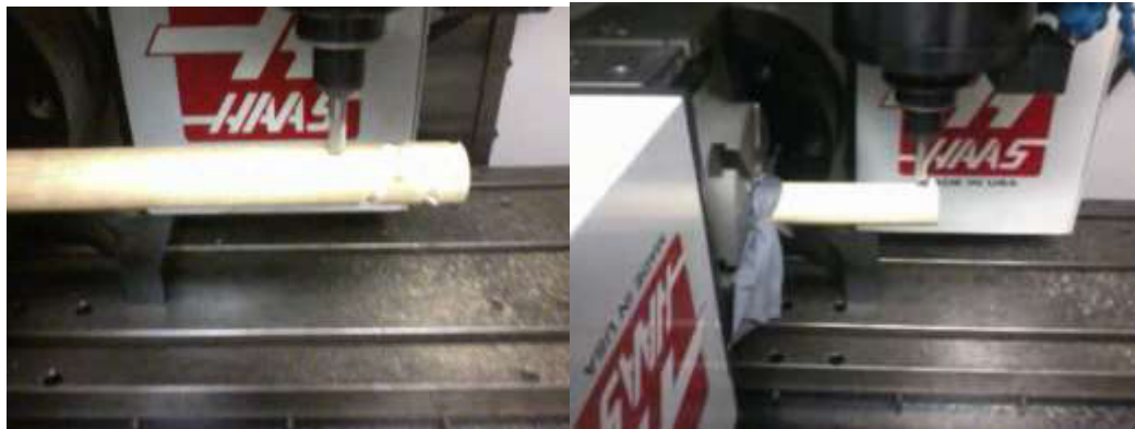
Figura 42. a) Proceso de maquinado de la primera prueba. b) Proceso de maquinado con sujeción de la segunda prueba.
