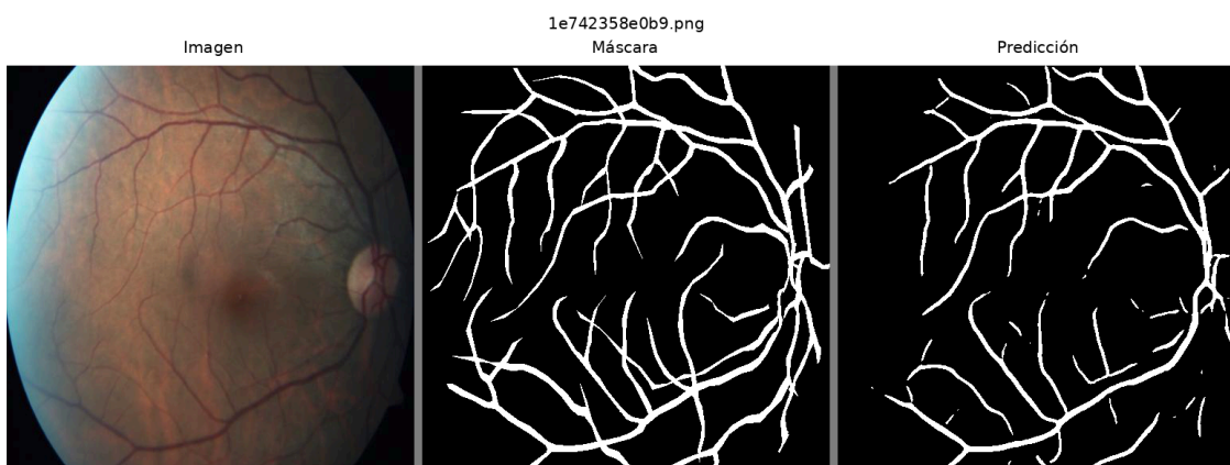
Figura 4.34. Resultado de segmentación vascular obtenido mediante U-Net. Se muestra la imagen original (izquierda), la máscara de referencia (centro) y la máscara predicha por el modelo (derecha). La predicción reproduce adecuadamente la morfología de los vasos principales, con algunas pérdidas en ramificaciones delgadas.
