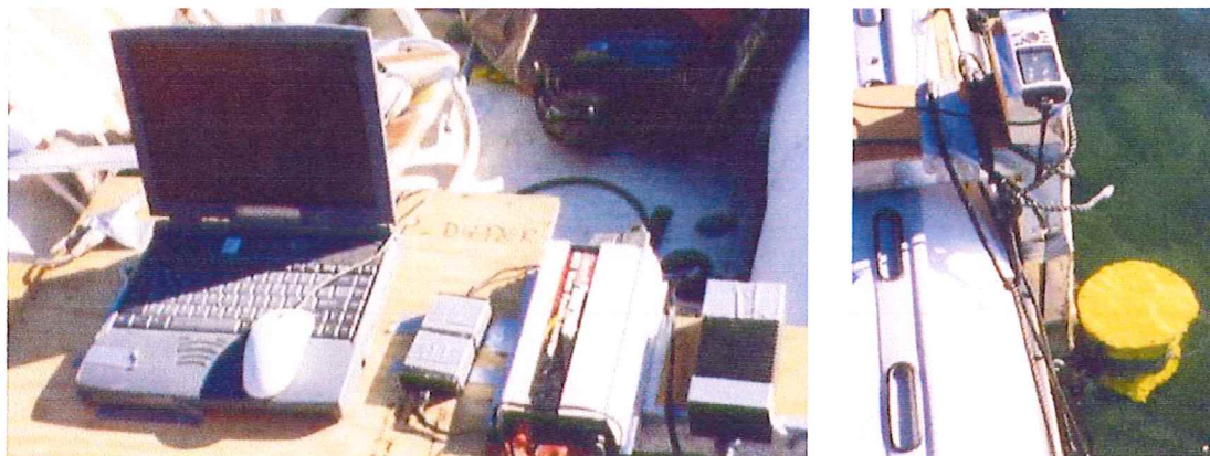
Figura 4. Equipo de navegación para la obtención de los datos de corrientes marinas.
