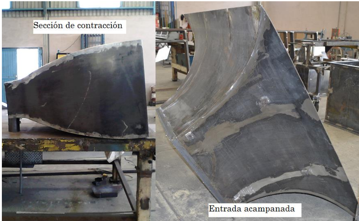
Figura 2.15: Piezas construidas en el taller de máquinas-herramientas.
