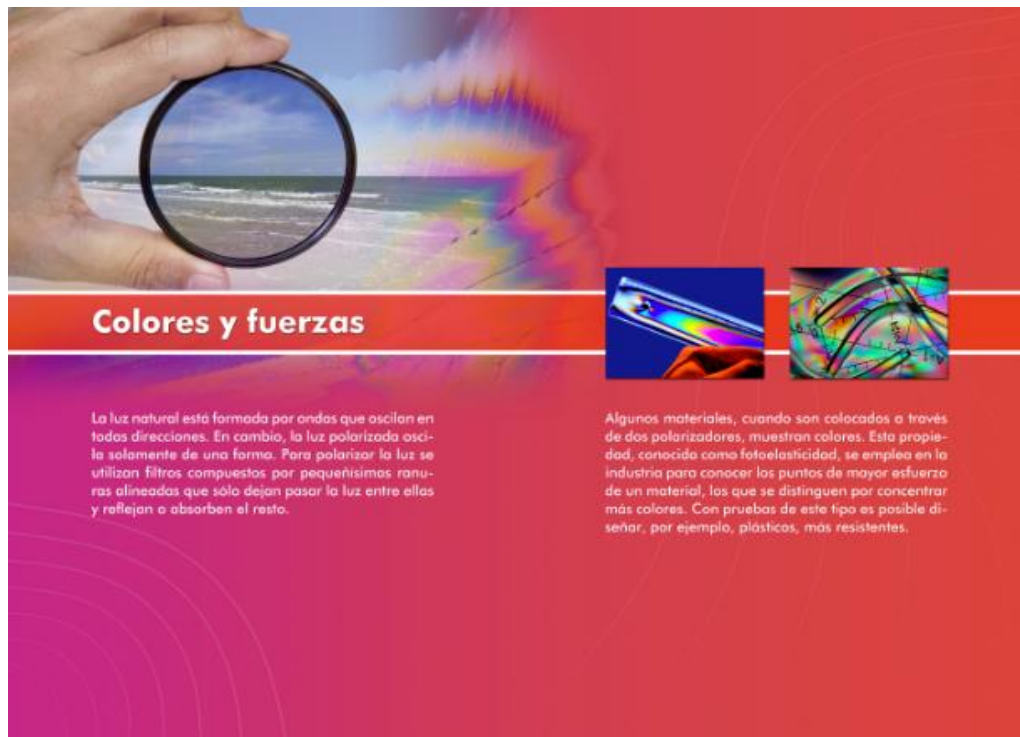
Figura 70. Cédula explicativa de la exhibición “Colores y fuerzas” e imágenes del fenómeno de fotoelasticidad que se puede observar en objetos de plástico.
