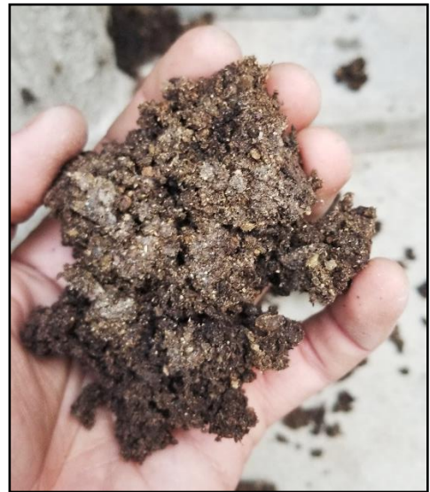
Figura 47. Primera prueba de extrusión de PP y aserrín con relación en masa 1:1.
