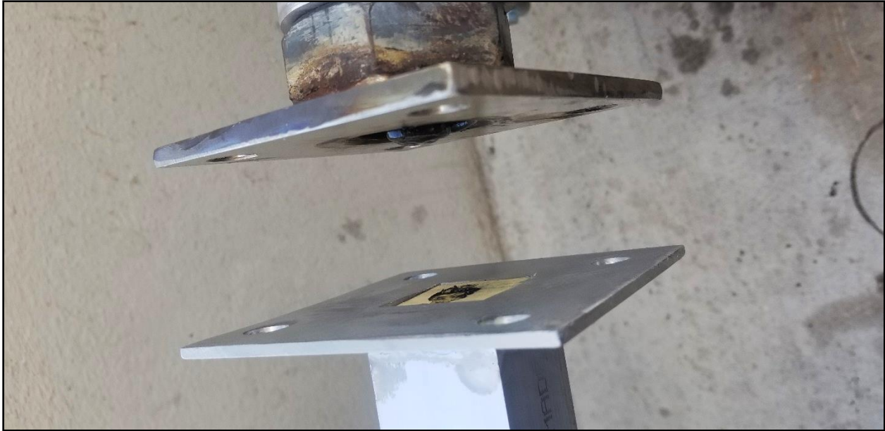
Figura 54. Unión de molde con salida de extrusora.
