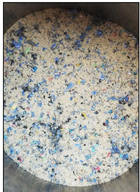
Figura 48. Mezcla con aserrín y PP 50 m% ambos materiales.
