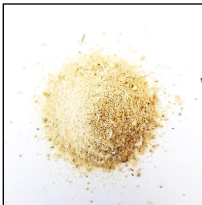
Figura 36. Aserrín 90-95 m% proveniente de madera de pino.
