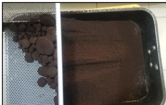
Figura 39. Criba de 1/8" para limpieza y selección de partículas \leq 0.125" de café.
