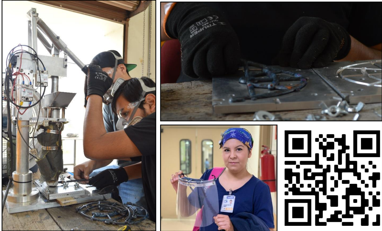
Figura 14. Inyección manual de polipropileno para reciclaje de caretas de protección.
