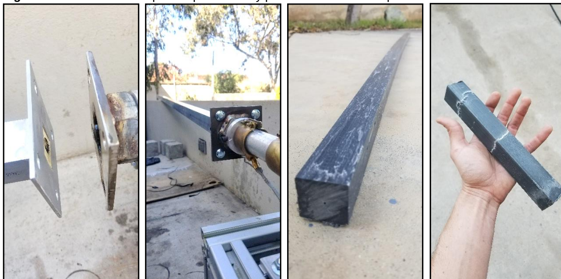
Figura 50. Unión de molde para especímenes y punta de extrusora de plástico.
