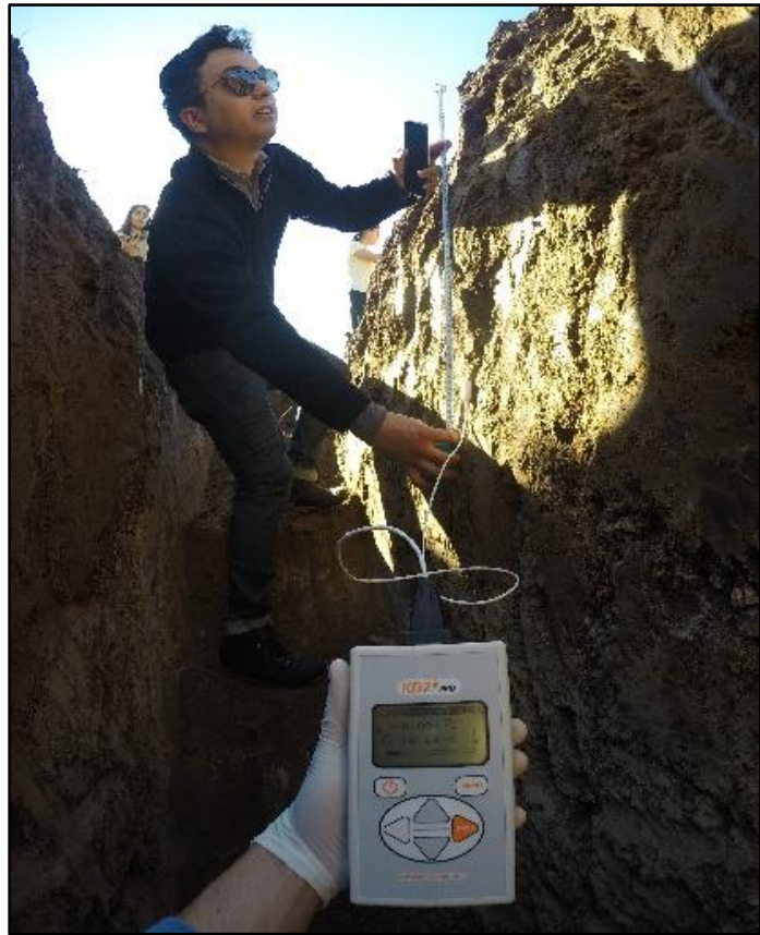
Figura 21. Análisis térmico in-situ (Sauzal, Ensenada)
