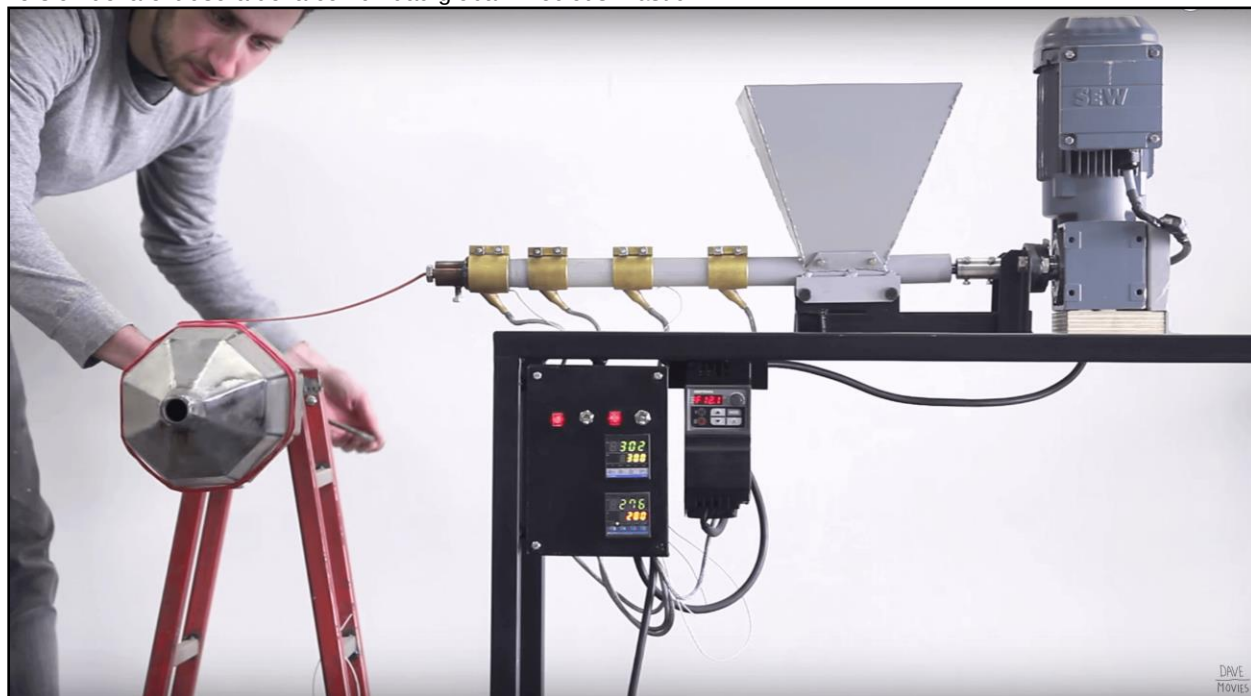
Figura 31. A la izquierda. Dave Hakkens creando una lampara a base de plástico reciclado. A la derecha. Primera versión de la extrusora de la comunidad global: Precious Plastic .
