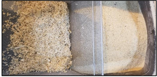
Figura 40. Criba de 1/8" para limpieza y selección de partículas \leq 0.125" de aserrín.
