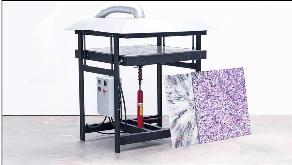
Figura 15. Máquina a compresión semi-industrial de reciclaje de plástico.
