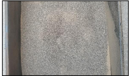
Figura 41. Malla de 1/16" para limpieza y selección de partículas \leq 0.0625" de suelo.
