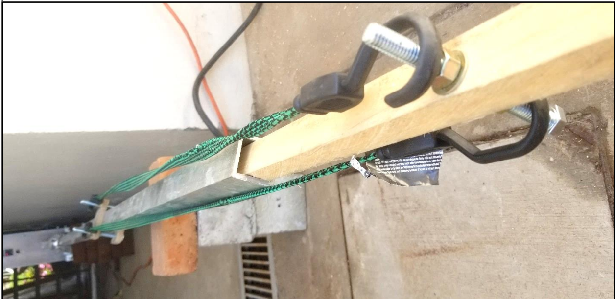
Figura 55. Inserción de barra de madera de pino en el otro extremo del molde y tensión mediante ligas para mantener presión al interior.
