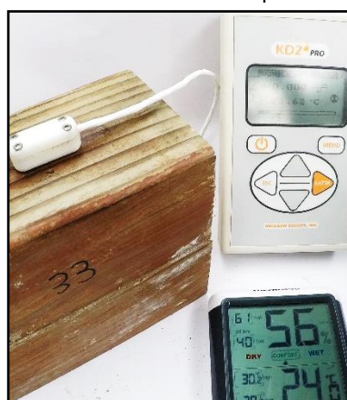
Figura 19. Análisis de propiedades térmicas de la madera de pino
