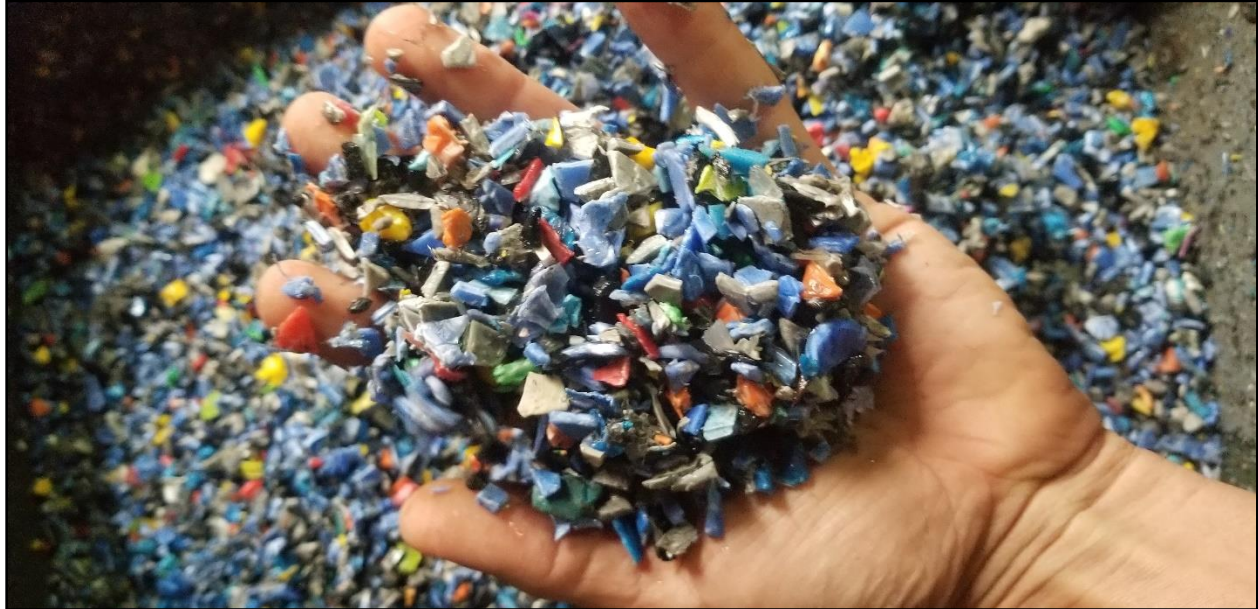
Figura 13. Polipropileno triturado en partículas \leq 3/8" en el Centro de acopio Tierra Viva de la ciudad de Ensenada.
