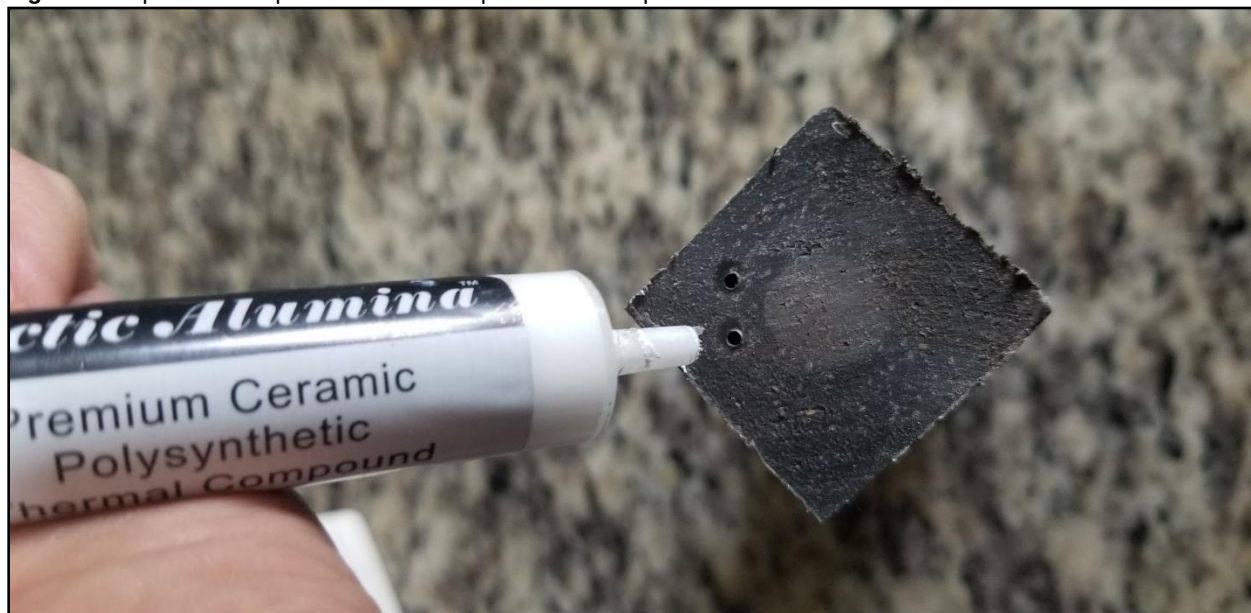
Figura 69. Aplicación de pasta térmica en oquedades de espécimen.
