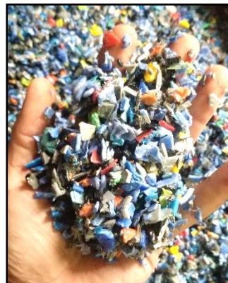
Figura 43. PP triturado en partículas de \leq 3/8" .
