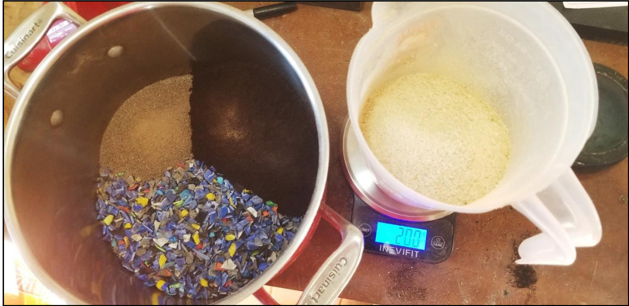
Figura 52. Pesaje de materiales conforme a dosificación.
