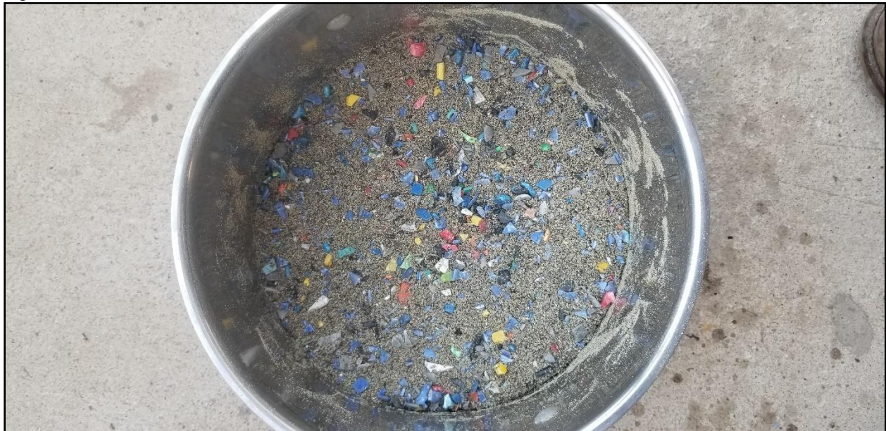
Figura 53. Mezcla en frío manual de la muestra WSC.
