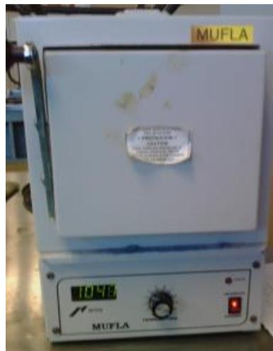
**Figura 8.** Proceso de sinterización del polvo de HA y FA en la mufla
