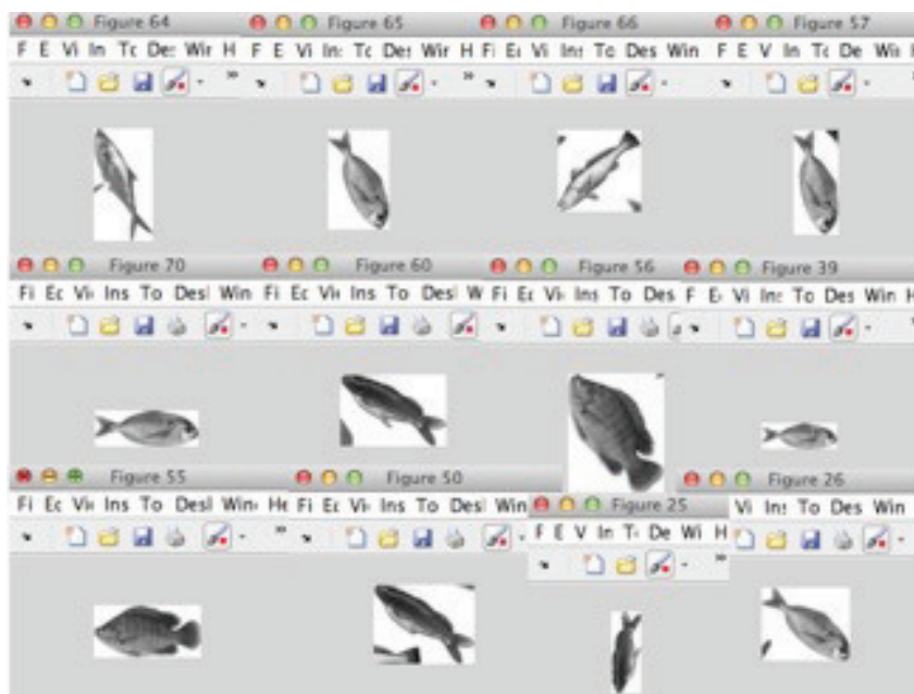
Figura 33: Ejemplo de extracción individual de los peces de la imagen original empleando momentos de Hu.
