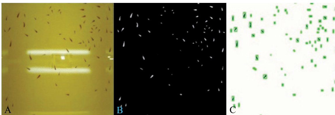
Figura 38: Resultados del procesamiento digital de la imagen de entrada usando Matlab: A) Imagen de entrada con 70 peces, B) Imagen binaria, C) Identificación de los peces.
