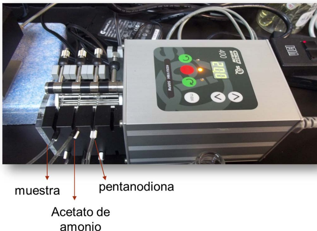
Figura 19.- Bomba peristáltica utilizada en el Laboratorio de Análisis de Agua de la Facultad de Ciencias Químicas e Ingeniería, UABC.
