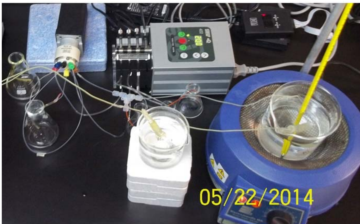
Figura 22.- Manta térmica donde se encuentra el reactor calentándose a 100 °C utilizado en el Laboratorio de Análisis de Agua de la Facultad de Ciencias Químicas e Ingeniería, UABC
