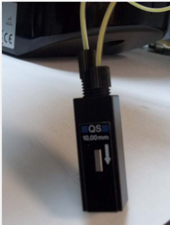
Figura 23.- Celda de cuarzo de flujo continuo de 10 mm utilizada en el Laboratorio de Análisis de Agua de la Facultad de Ciencias Químicas e Ingeniería, UABC
