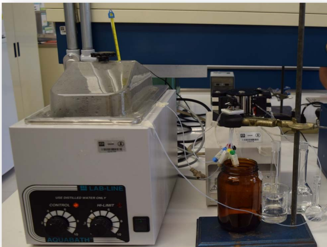
Figura 14.- Sistema FIA utilizado en el Laboratorio de Análisis en Flujo de la Facultad de Química, UNAM.
