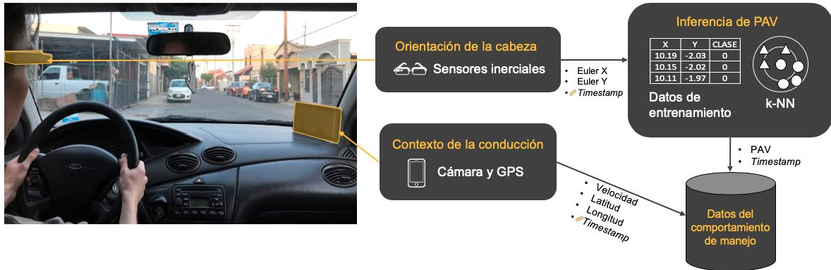
Figura 4.1. Arquitectura del sistema para la recolección de datos mediante el uso de sensores.
