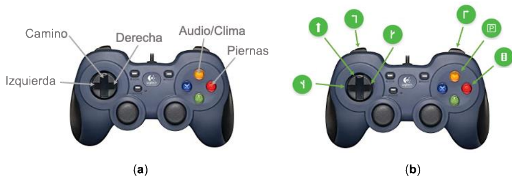
Figura 5.3. Logitech Gamepad F310: a) Mapeo de controles para el Componente de Validación, b) Mapeo de controles para el Componente de Recolección de Datos del Comportamiento al Conducir.
