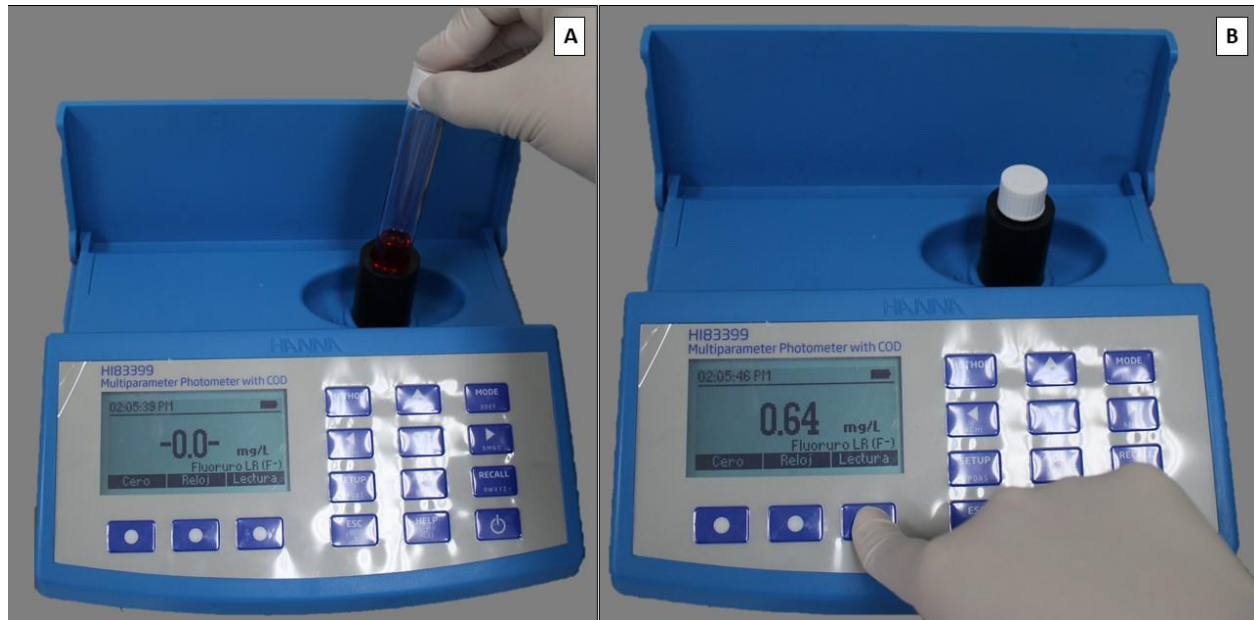
Figura 13. Medición de muestras en fotómetro multiparamétrico. A) Colocación de muestra problema B) Medición de muestra problema.
