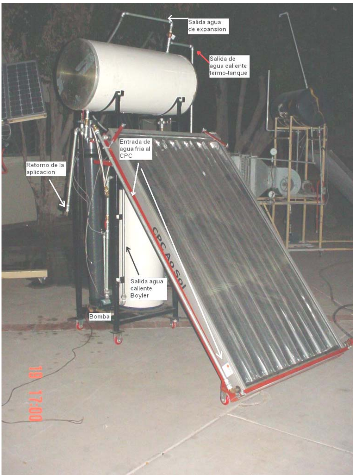
Figura 4.22 Calentador solar de agua con sistema de tuberías (vista 2).
