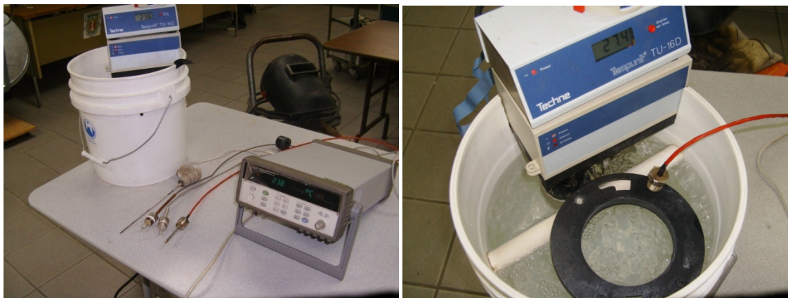
Figura 4.28 Baño maría para calibrar el resto de RTD's.
